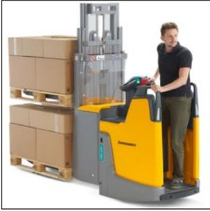
Doppelstockbetrieb für schnellen Warentransport und Doppelstockbelastung
