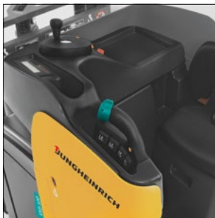
Ergonomische Fahrerplatzanordnung beim ESD 120
