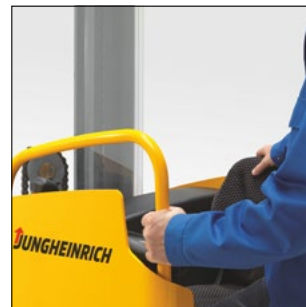
Haltebügel für sicheren Aufstieg und als Montagemöglichkeit für verschiedene Optionen
