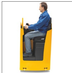
Komfortable Sitzposition mit höhenverstellbarem Bodenblech beim ESE 220/320
