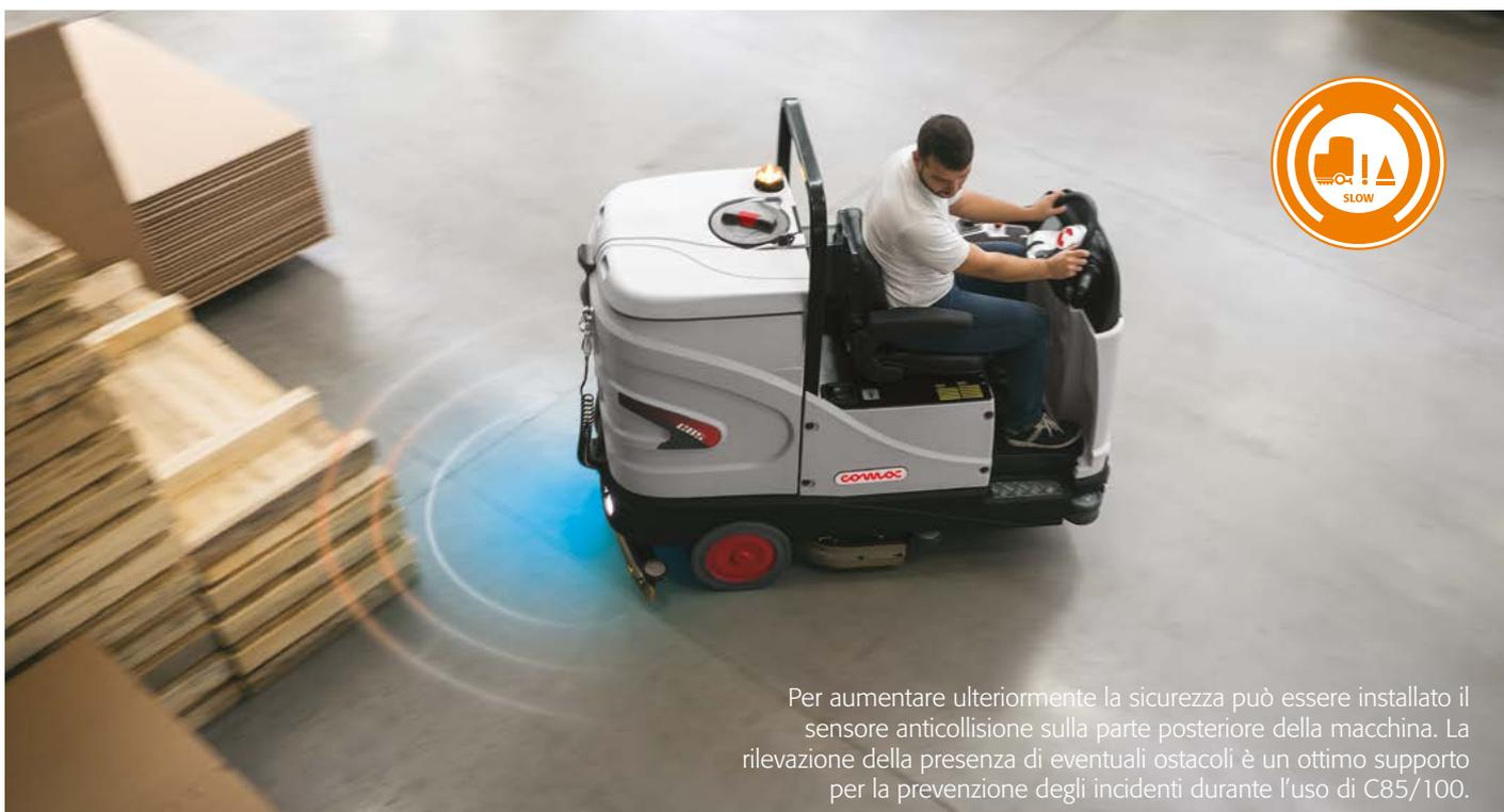
Per aumentare ulteriormente la sicurezza può essere installato il sensore anticollisione sulla parte posteriore della macchina. La rilevazione della presenza di eventuali ostacoli è un ottimo supporto per la prevenzione degli incidenti durante l'uso di C85/100.
