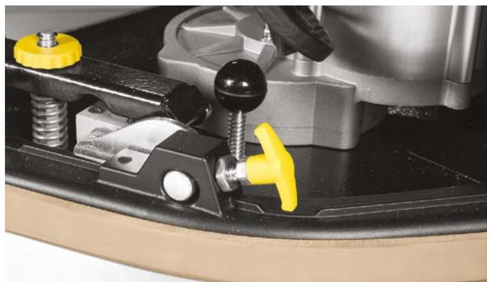
Il sistema di sgancio spazzole avviene mediante un pomellino, che posizionato sul basamento, facilita notevolmente questa operazione.
