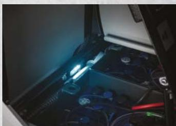
C85/100 può essere dotata di pacchetto luci di cortesia a led per aumentare la visibilità delle parti dove l'operatore potrebbe svolgere la manutenzione.
