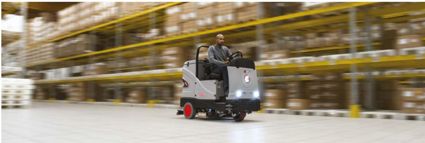
Operazioni di pulizia rapide per ottimizzare i tempi: fino a 8 km/h in lavoro. Un sensore continuo posizionato sull'asse dello sterzo riconosce la posizione esatta della motoruota anteriore riducendo automaticamente la velocità della macchina in base alle necessità. Il sensore permette a C85/100 di avanzare in modo fluido e senza vuoti.
