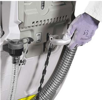
La catena di abbassamento del tergilavaggio è robusta, realizzata in acciaio, e dotata di una maniglia ergonomica in pressofusione di alluminio
