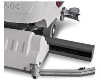
La versione spazzante (Antea 50 BTS) è dotata di un cassetto di raccolta per piccoli residui solidi. Si può facilmente svuotare sfilandolo lateralmente
