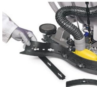
La sostituzione e la rotazione delle gomme del tergilavaggio si realizzano in pochi istanti e non è necessario l'utilizzo di utensili
