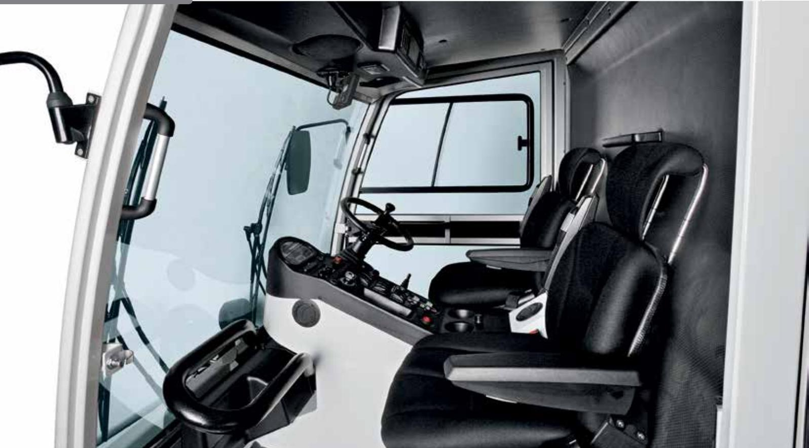
La cabina è confortevole perché spaziosa e isolata tramite i supporti antivibranti. È comoda nella guida, molto luminosa e ampiamente vetrata per consentire all'operatore la massima visibilità esterna, rendendo più facili le manovre ed il controllo della zona interessata dalla raccolta.
