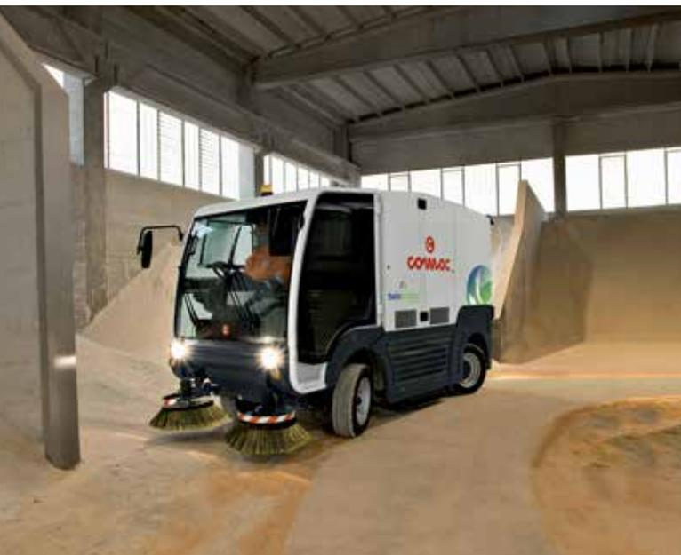
CS140 T, presenta **un sistema sterzante integrale sulle 4 ruote** con angoli anteriori e posteriori simmetrici (centro di rotazione unico per i due assali) ed un raggio di sterzata di 4,25 m.
