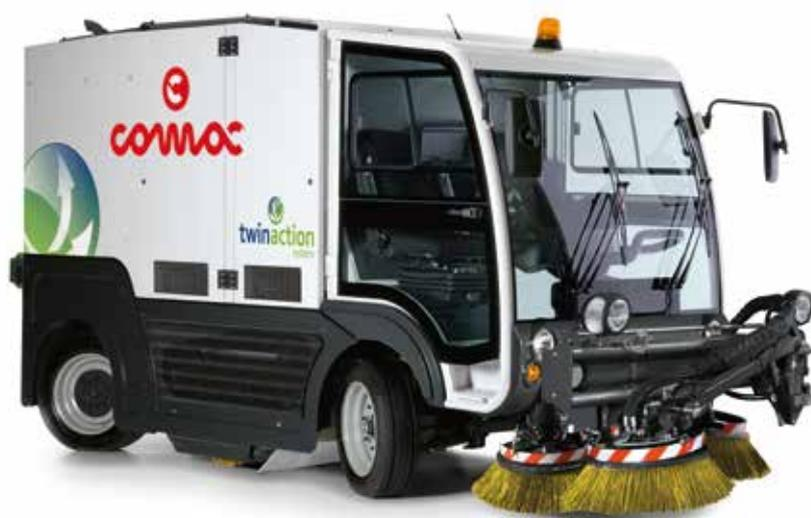
**CS140 T** da 3,5 m<sup>3</sup>, unisce in un'unica macchina particolarmente compatta le prestazioni di due, combinando due azioni in un'unica soluzione, assicurando il massimo risultato qualitativo.
