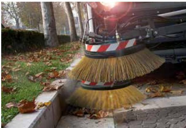
Le spazzole laterali possono essere dotate di speciali ugelli per la nebulizzazione dell'acqua (optional) efficaci per controllare le polveri durante l'azione spazzante
