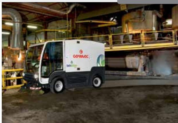
Comac ha realizzato uno speciale dispositivo di controllo che, agendo separatamente sulle quattro ruote, mantiene costante l'altezza da terra anche al variare del carico, ottimizzando il lavoro e la stabilità. L'operatore può posizionare la macchina su tre diversi livelli prestabiliti per assecondare diverse necessità.
