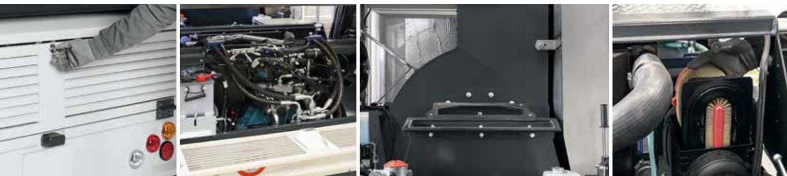
Il filtro dell'aria motore e il radiatore dell'olio idraulico sono collocati nella parte posteriore della macchina ed accessibili da uno sportello che si può aprire anche con il cassone abbassato.
