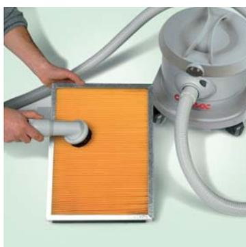
È importante pulire ad ogni ciclo di lavoro il pannello filtro con un aspiratore per garantire un ottimo funzionamento della macchina
