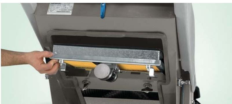
Il filtro a pannello è facilmente sostituibile senza l'uso di utensili
