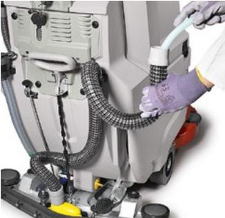
Per assicurare un'asciugatura sempre perfetta è fondamentale eseguire al termine di ogni intervento la pulizia del tubo aspirazione e delle gomme del tergovivimento. Quest'ultimo si può sollevare per permettere di accedere alle gomme con facilità e pulirle rapidamente
