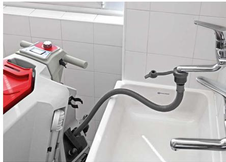
Il tubo per il riempimento del serbatoio soluzione si può collegare direttamente ad un qualsiasi rubinetto, dando la possibilità di rifornirsi ovunque e rendendo l'operazione più rapida
