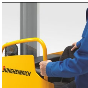
Maniglia di sostegno per una salita sicura e possibilità di montaggio di varie opzioni
